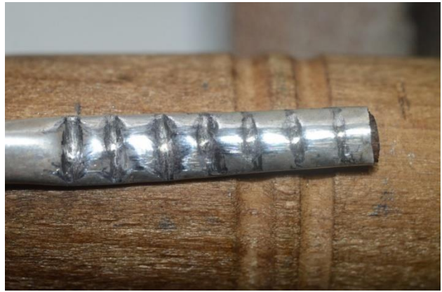
図 10 彫刻した藤つるの下地に銀板を巻き付け、千枚通しとへらで押さえて粒を成形
