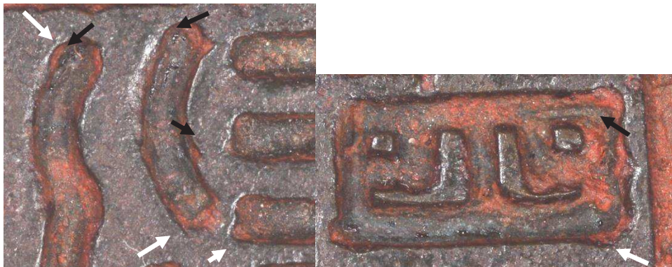
図4 No.519 二段彫り (白矢印) とボールエンドミル (?・黒矢印) の加工痕
