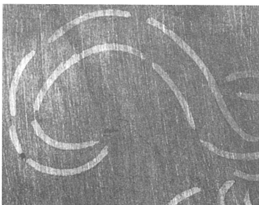
(8)最後に、荒目、中目、名倉の砥石で表面を磨きます（図8の上半身全部）。
