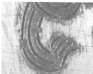
(5)溝の淵（内側）を薄い平たがねで起こします。
