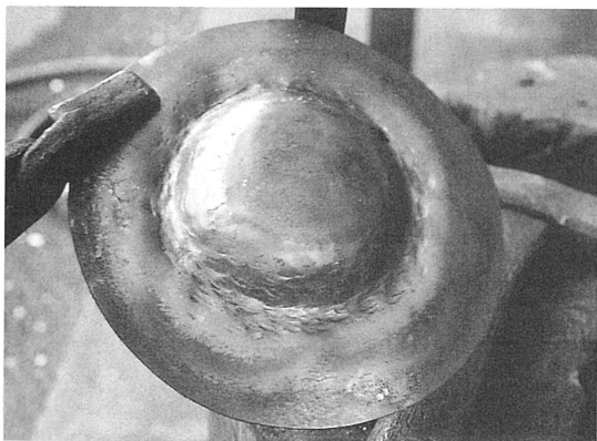
写真17 本体半球形部分の絞り加工
