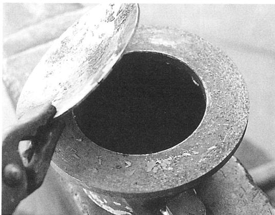
写真7 脚部分の鍛造用沿わせ型
