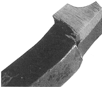
写真11 旋盤用バイトの加工
