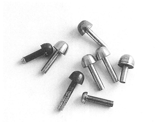
写真12 鋏頭部を研削して完成
