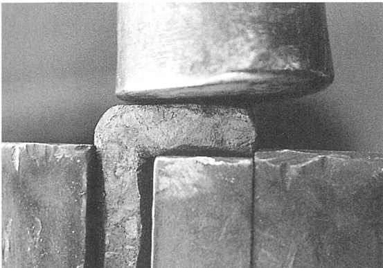
写真17 角部分の据込み加工
