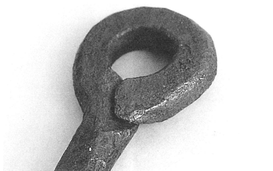
写真6 重ねた部分に段差が見える
