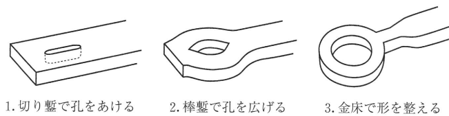
図3 打ち抜きによる輪環の製作工程
