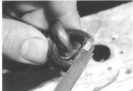
写真44 ヤスリによる削り出し
