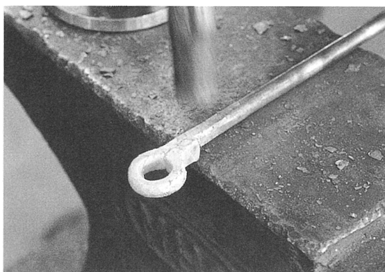
写真31 鍛接部の整形
