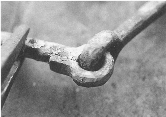
写真41 先に製作された輪環をガイドにして連結部分の製作を行った
