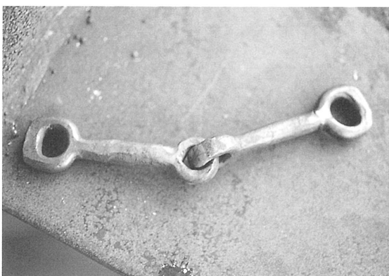
写真38 鍛接部分の整形を終えた状態
