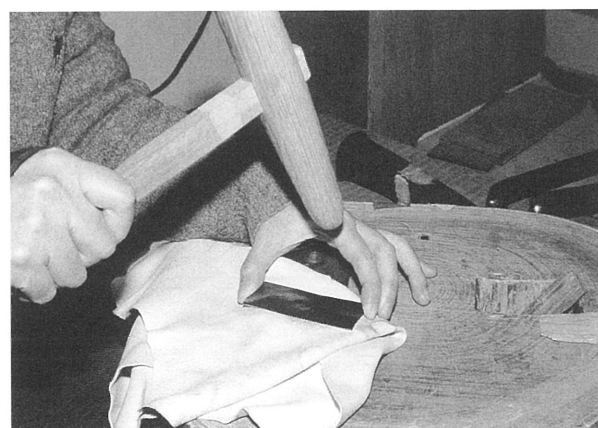
写真5 鉄板を木槌で軽く打出す。
