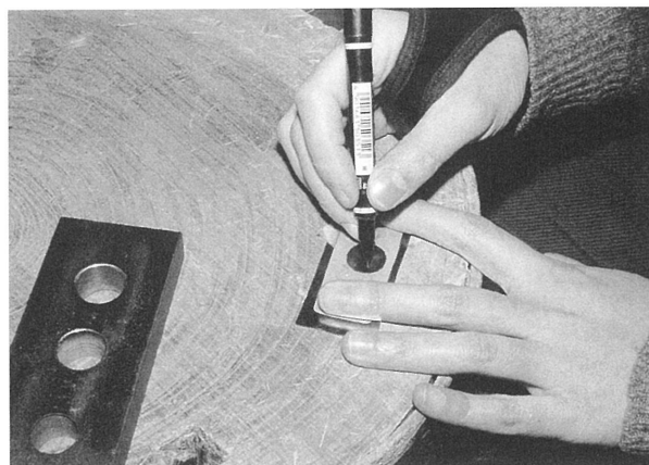
写真4 打出しの位置を鉄板の裏面に印す。
