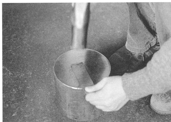
写真3 0.71ミリの鉄板を打ち延べる。
