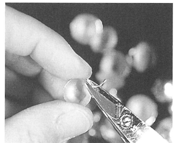
写真168 半球形の縁を切断する
