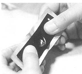
写真63 金銅板を鉄地に馴染ませる
