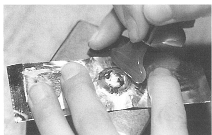
写真70 ヘラで金銅板をさらに密着させる
