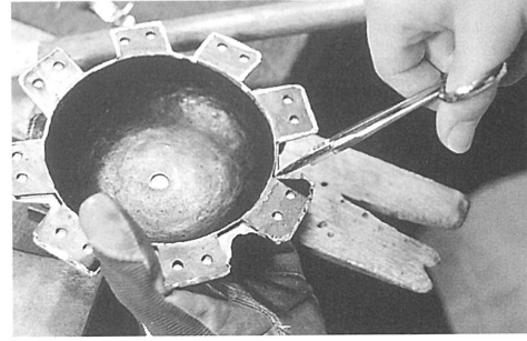
写真111 時計方向に脚を半分被せたところ
