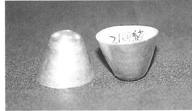
写真153 21回目の絞り加工
