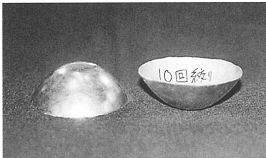
写真151 10回目の絞り加工
