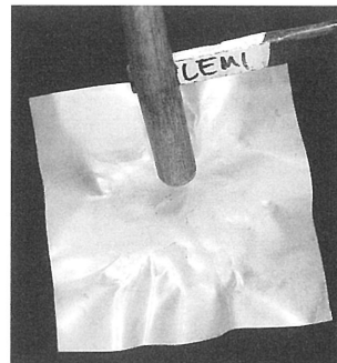
写真87 裏側から打ち出す
