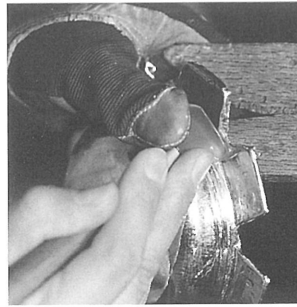
写真110 ヘラで金銅板を側面に倒す
