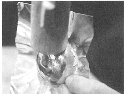
写真136 当て金で半球形の側面を絞る
