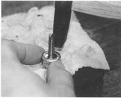
写真160 金鏈で打って固定する
