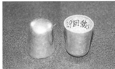
写真155 29回目の絞り加工
