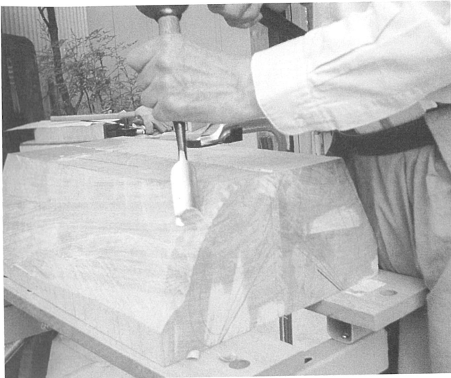
写真8 居木製作 外側加工(3)
