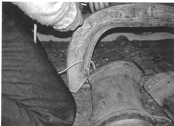
写真4 鞍の組み立て
