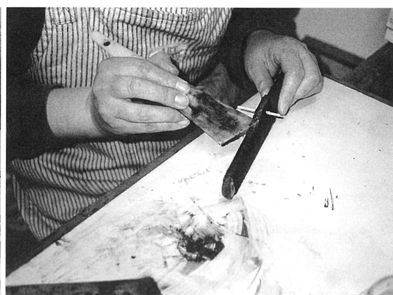
写真4 鞘の表面仕上げ
