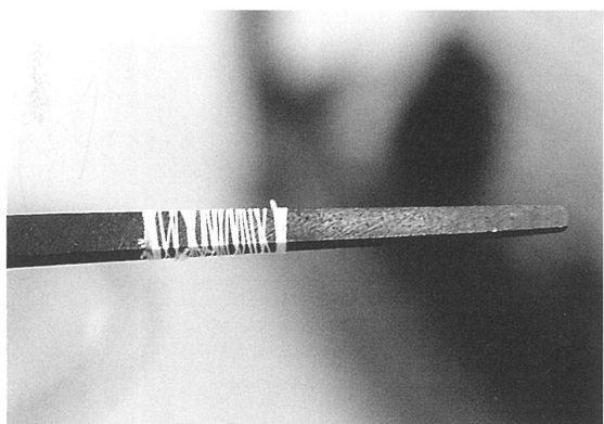
写真28 軸の太さの調整
