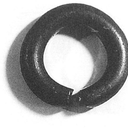
写真2 銅芯切断後、曲げ加工
