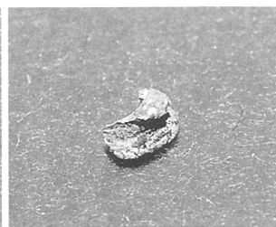
写真5 破損したパイプの一部分 (固定した様子がわかる)
