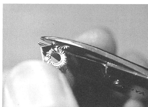
写真15 金鋏で円形に切断する
