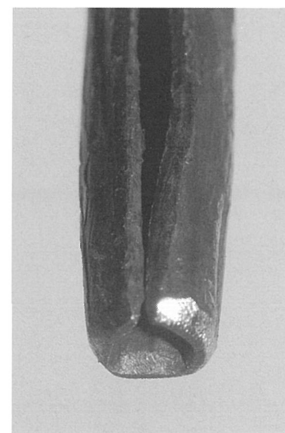
図 11 丸棒を引き抜いた直後の円文たがね
