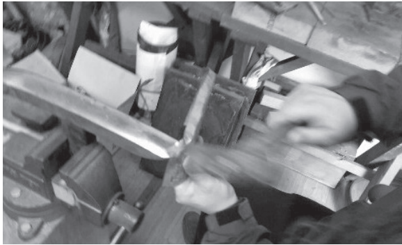
図23 下縁部の鍛造成形
