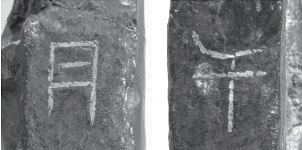
別図 2 中平銘鉄刀の蹴り彫り象嵌
