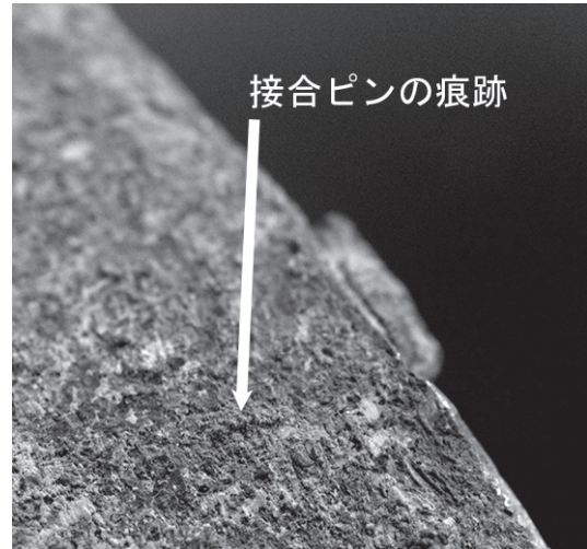
図15 鐔と鈴の接合ピンの痕跡
