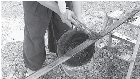
写真206 水に藁灰を混ぜて刀身を洗う
