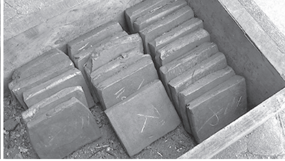
写真62 下鍛えした短冊の完成
