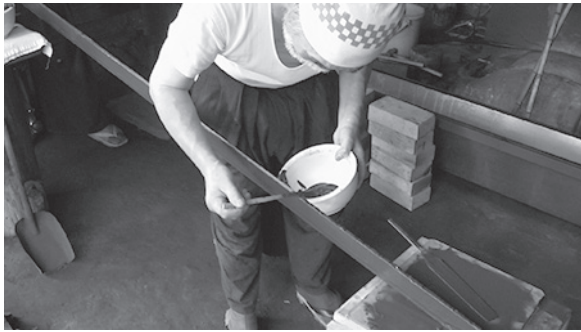
写真210 刀身に焼刃土を塗る
