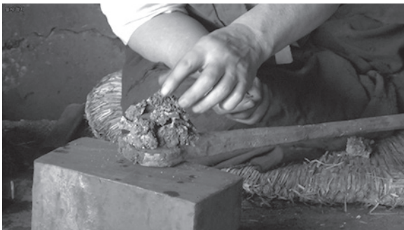
写真46 新しい玉鋼を乗せる
