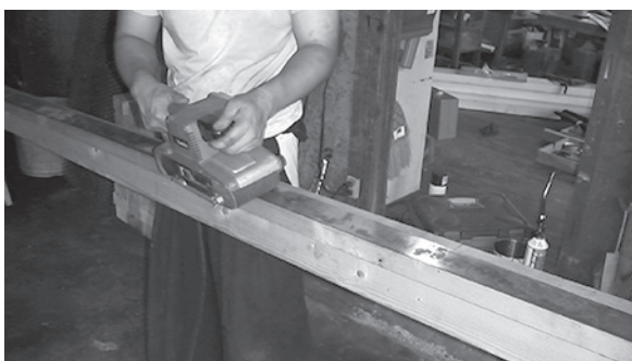
写真204 刀身表面の凸凹をなくす
