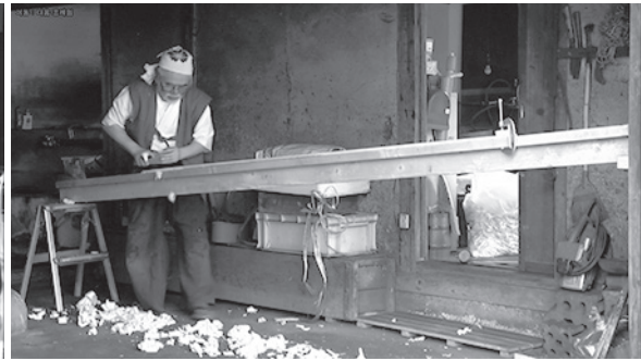
写真23 鉋で木製刀身の表面を削る
