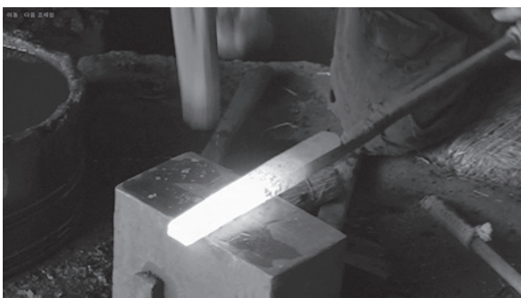
写真36 直方体の形に鍛造した心鉄
