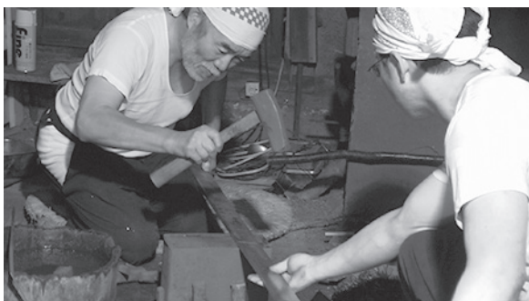
写真202 手鋸で刀身の歪みを整える
