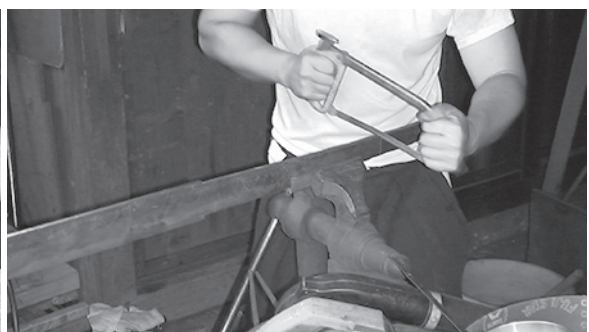
写真231 茎を所定の寸法に切る
