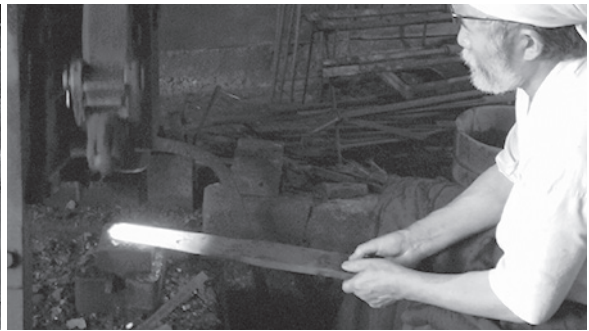
写真172 試作の火造り
