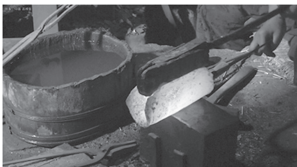
写真147 3次皮鉄に「2次組み合せた鉄塊」を入れる
