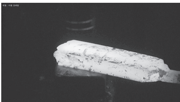
写真102 直方体の形に鍛造
