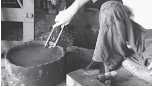
写真41 心鉄を水の中に入れて冷やす
