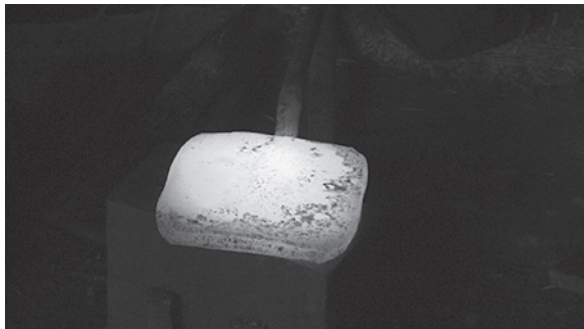
写真143 「5枚の短冊を接合した大きい塊」鍛造
