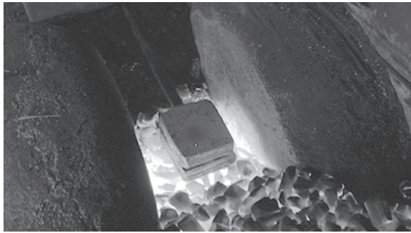
写真141 「5枚の短冊を接合した大きい塊」2個の沸かし付け
