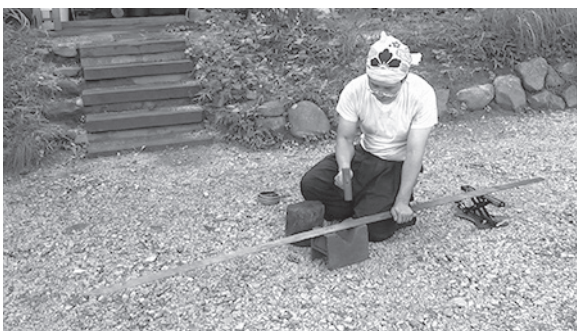
写真203 手鋸で刀身の歪みを整える
