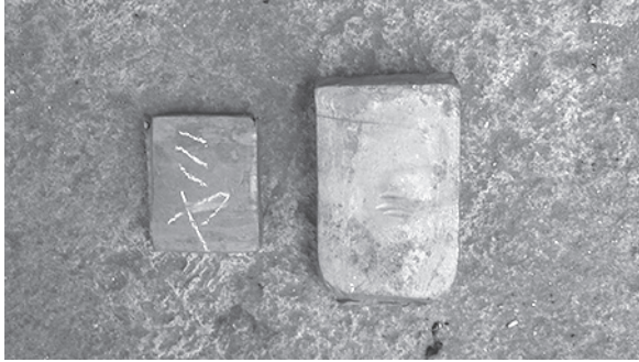
写真112 下鍛えした短冊と「5枚の短冊を接合した 大きい皮鉄」
