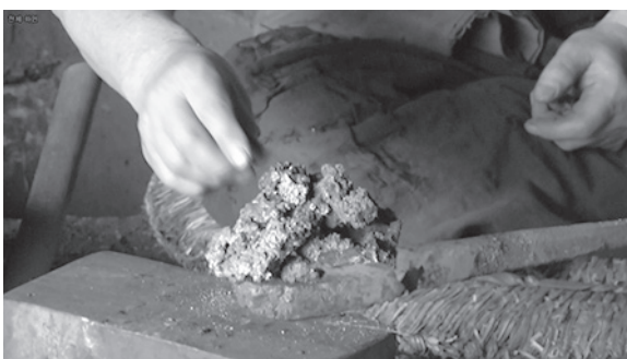
写真32 新しい玉鋼を乗せる
