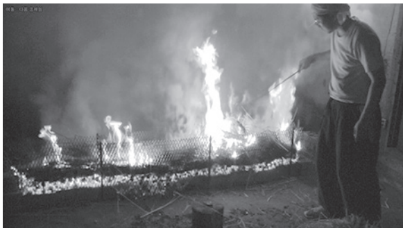
写真198 焼き鈍しのために藁を入れて藁灰とする
