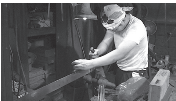
写真205 刀身表面の凸凹をなくす
