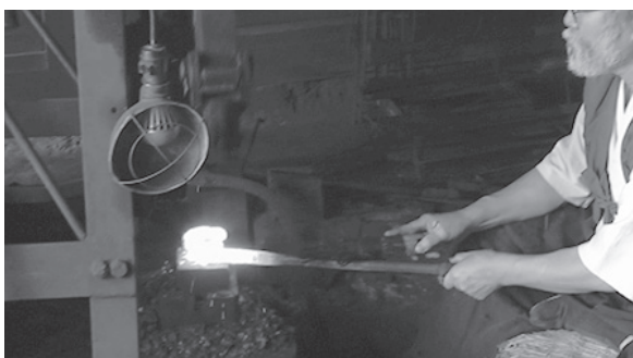
写真31 機械ハンマーで鍛錬
