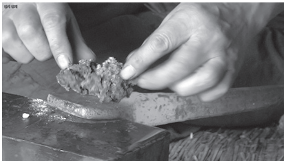
写真43 テコ棒の先端に玉鋼を乗せる
