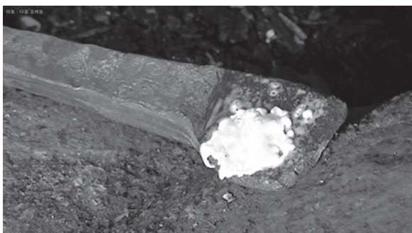
写真27 テコ棒の先端に硼砂をまく
