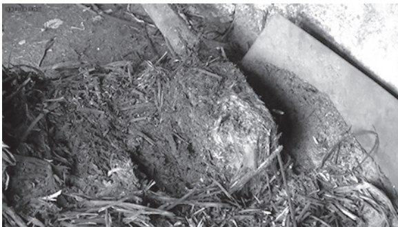
写真54 玉鋼に藁灰を付ける
