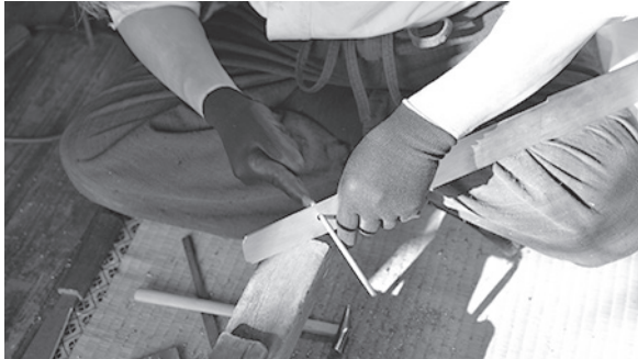
写真238 穴のバリを取る
