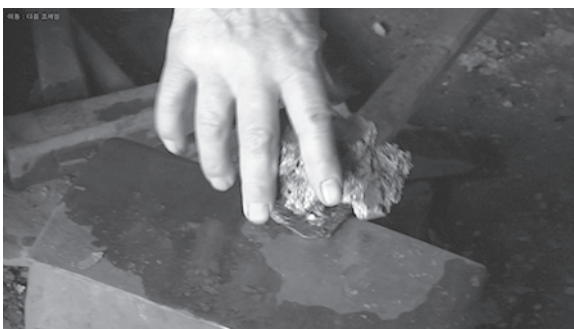
写真28 テコ棒の先端に玉鋼を乗せる
