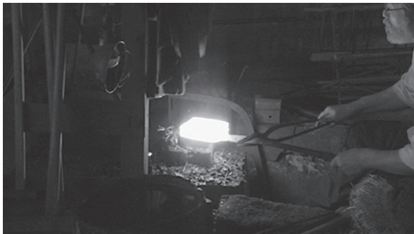
写真142 「5枚の短冊を接合した大きい塊」を鍛造
