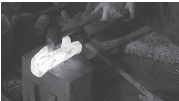
写真124 2次皮鉄の成型
