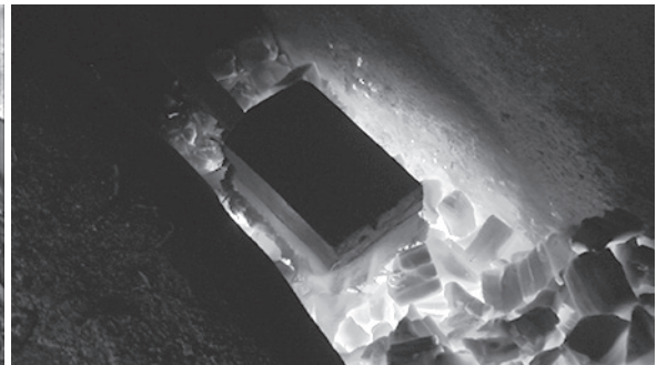
写真115 「5枚の短冊を接合した大きい皮鉄」2つ を過熱
