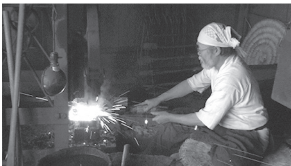
写真116 「5枚の短冊を接合した大きい皮鉄」鍛接
