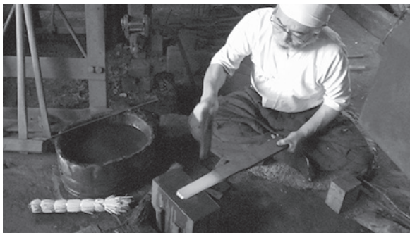
写真173 試作の火造り
