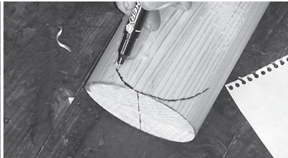
写真38 鞘の先端の形
