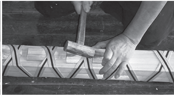
写真28 くさびを打ち込む
