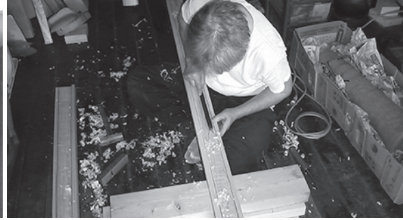
写真8 内側を鑿で削り出す②
