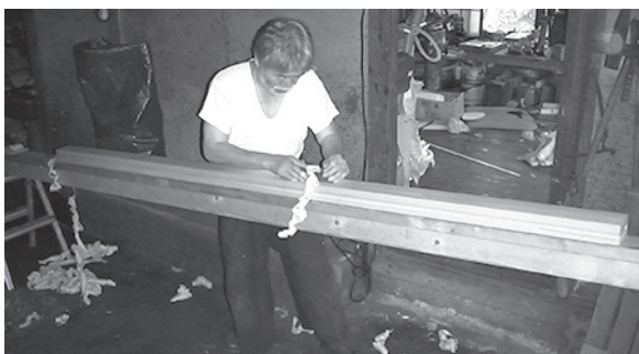
写真32 鞆の外側を削る
