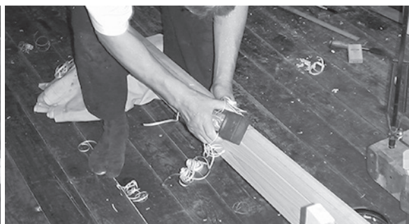
写真33 鞆の外側を削る
