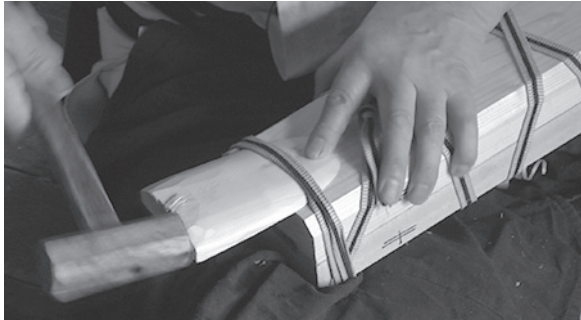
写真16 楔を打ち込む
