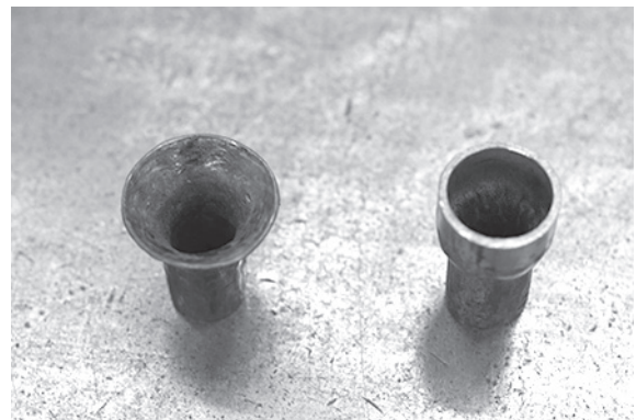
図4-6 紐懸通孔の筒金具2
