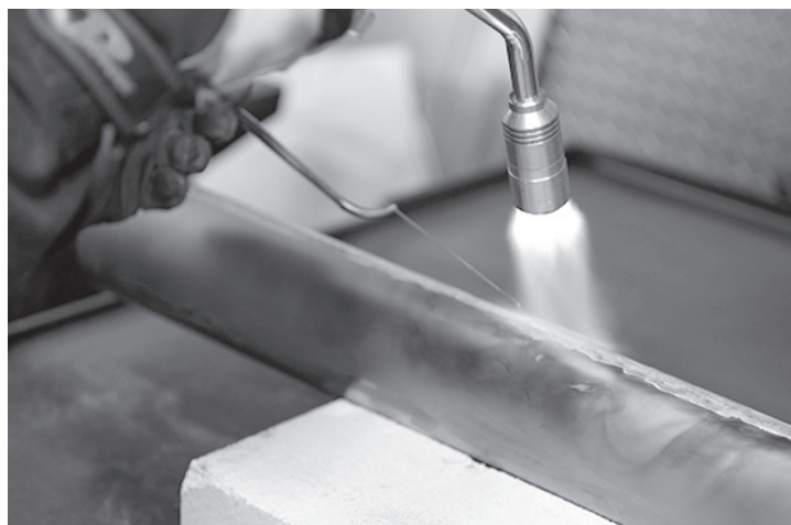
図3-15 鞆尻金具のロウ付け
