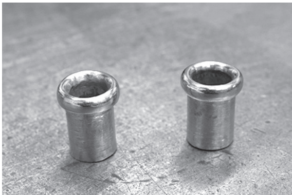
図4-11 紐懸通孔の筒金具
