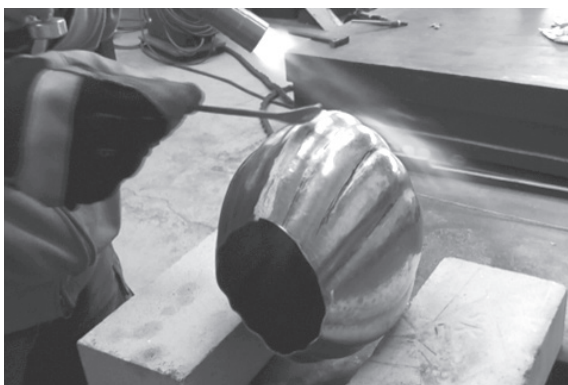
図1-18 銀ロウによるロウ付け接合
