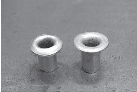
図4-7 紐懸通孔の筒金具3 縁を開く
