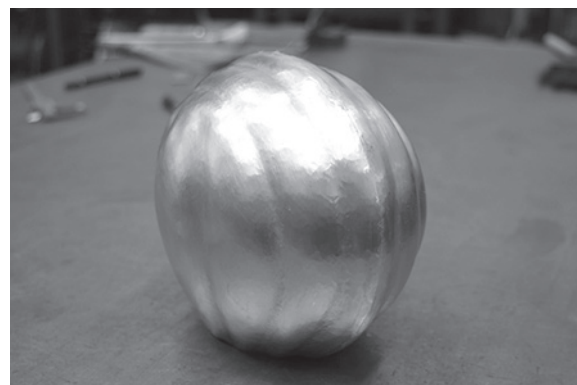
図1-19 銀ロウによるロウ付け接合
