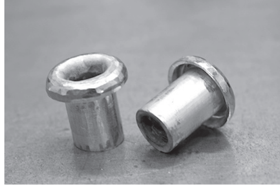
図4-8 紐懸通孔の筒金具4 縁を曲げる
