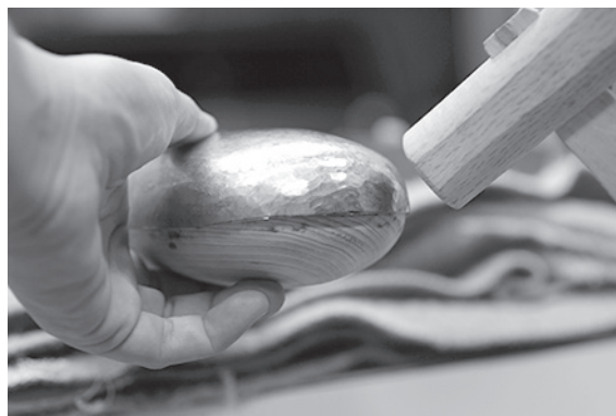
図3-14 銅板の絞り加工
