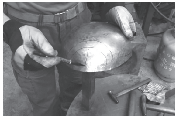
図1-15 凹ませる基準点を決定
