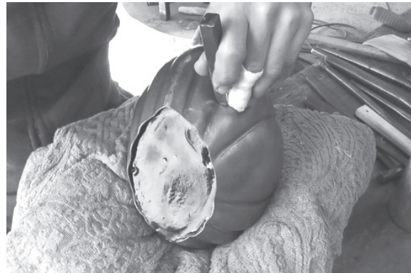
図1-21 タガネによる加工
