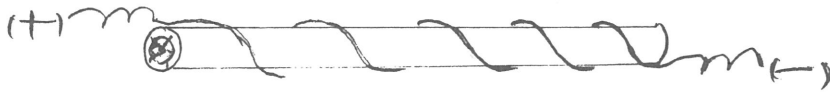
図4 棒状電気ヒーターと枝材のまわりにアルミ箔を巻き付け再加熱
