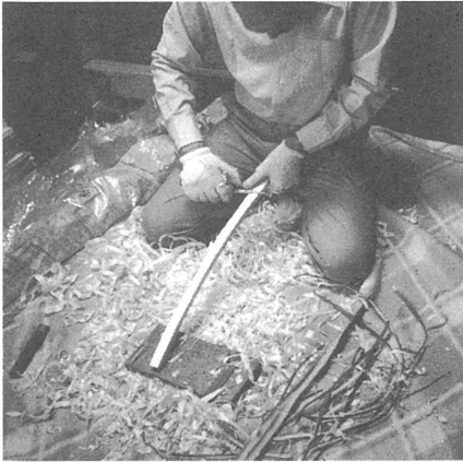
図11 「桑材を角材にする」
