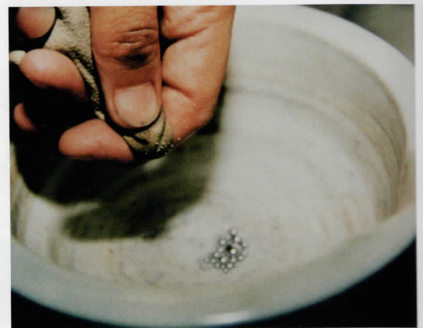
写真5 金アマルガムを鹿革で濾して余分な水銀をとる
