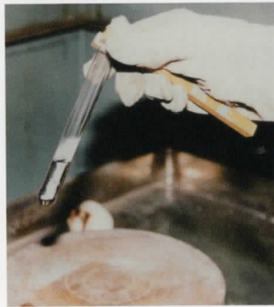
写真2 試験管の中に入れた金と水銀を熱する
