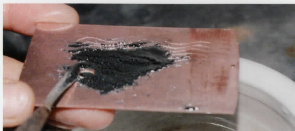
写真7 酸洗した銅板にアマルガムを塗る
