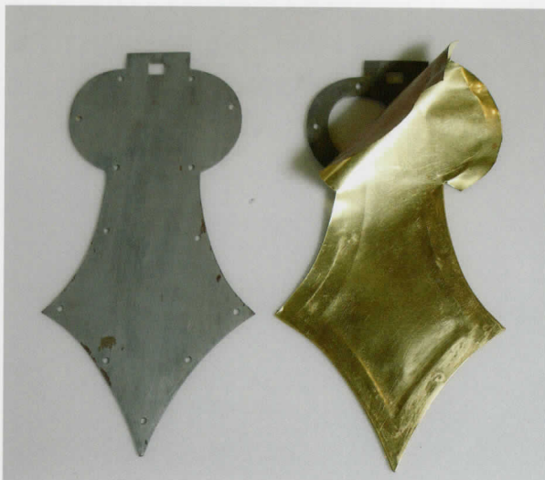
71.石光山8号墳 剣菱形杏葉の復元製作工程
