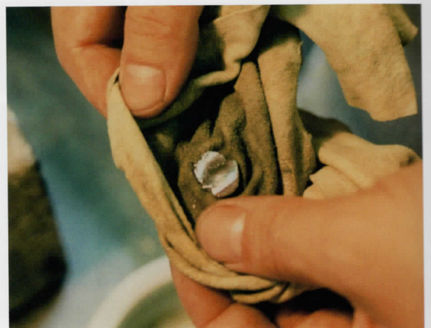
写真6 濾し終わったアマルガム一耳たぶ程の固さになる
