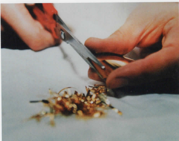
写真1 純金板を短冊状に切断する
